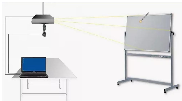
Рисунок 2. Принцип действия интерактивной области IQ Board LT
